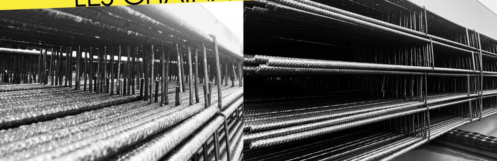
Les **CHAINAGES PLATS ARMETON®** à 2 filants, référence CHE410, sont des armatures de **CHAINAGES ARMETON®**, dont la fonction est la **limitation du risque d'écartement** et de flambement dans l'ouvrage (écartement par exemple en tête de mur ou de pignon, flambement par exemple en coin de mur ou dans les parties verticales à contreventer).
