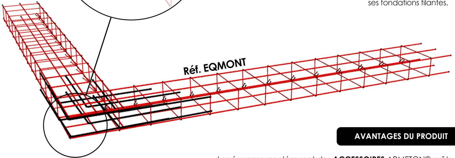
Les équerres-montées sont des **ACCESSOIRES** ARMETON®, dont la fonction est la liaison des longrines (armatures de **FONDACTIONS ARMETON®**). Ces produits permettent le parfait recouvrement des filants des armatures, en diamètres, quantité, espacements et longueur, assurant ainsi l'utilisateur de réaliser une liaison réglementaire et efficace de ses fondations filantes.
