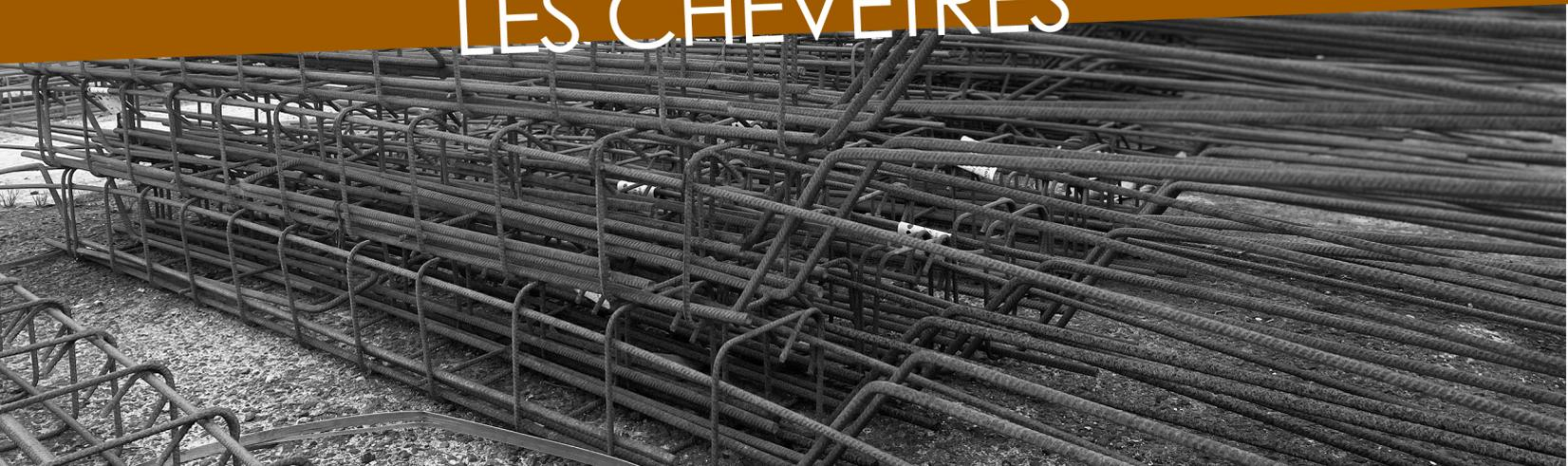
Les **CHEVÊTRES** sont des **armatures ARMETON®**, dont la fonction est la **limitation du risque de cisaillement** (effort tranchant vertical sous l'effet de la charge) et de **flexion** (déformation verticale sous l'effet de la charge), au niveaux des planchers.
